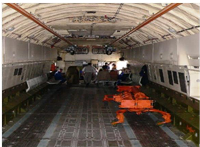
Foto de la espaciosa cabina para carga general del Antonov IL-76 Ilyushin con capacidad para 47 toneladas
